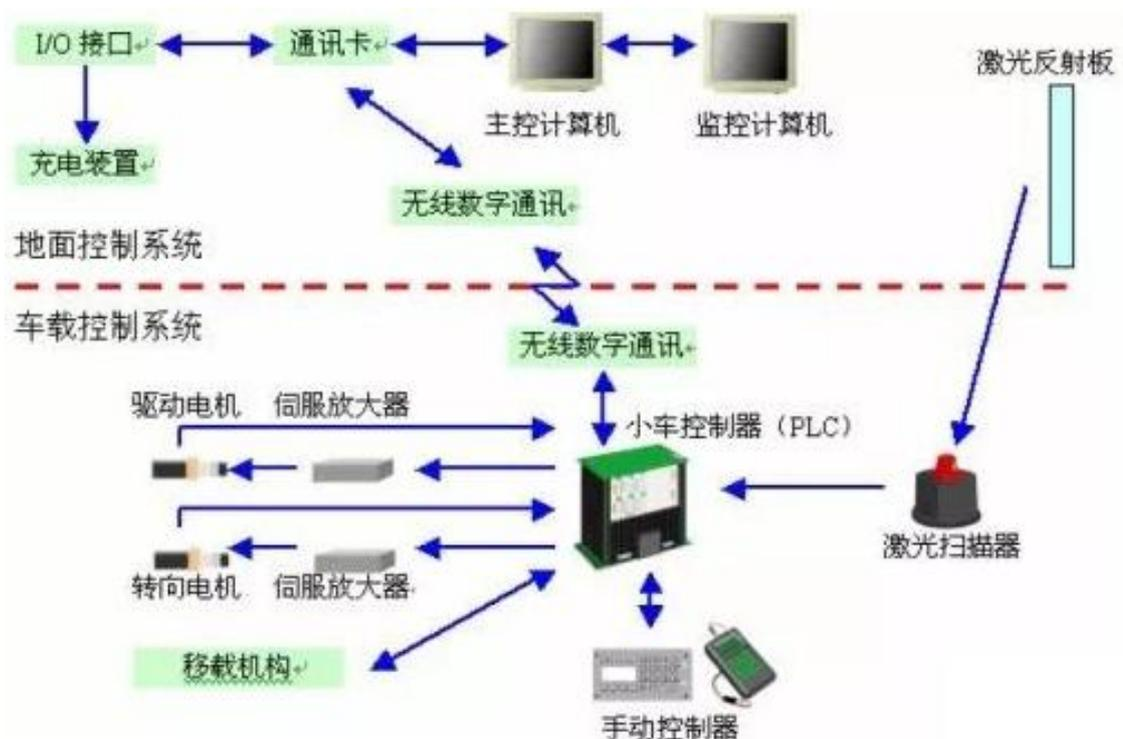
图 6AGV 系统的硬件配置实例
